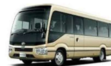
マイクロバス ：既存のバス（コースター）を水素燃料電池型に改良することで実現
