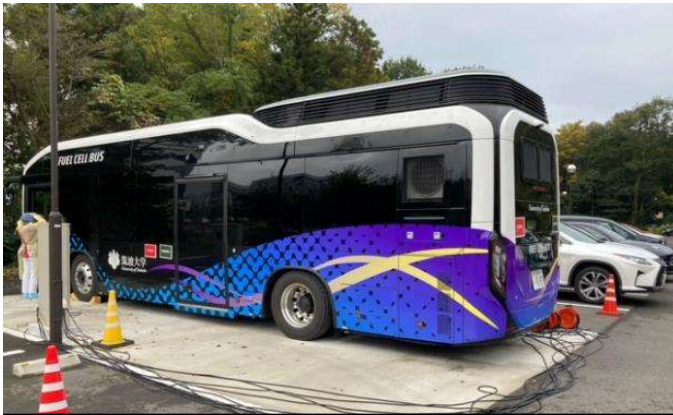
系統電源からの給電試験
